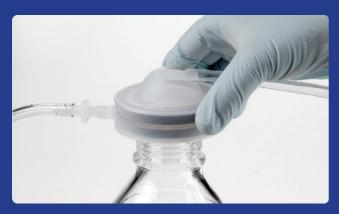
3. 送液用チューブをろ過する溶媒の中に入れます。このチューブが溶媒容器の底にあることを確認してください。サムクランプを溶剤ボトルの上に置いて、クランプを閉じます。
