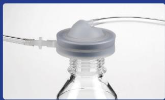
4. ソルバックのフィルターハウジングを押さえながら、真空ポンプの電源を入れ、システムに適切な圧力を加えます。真空状態になったら、サムクランプを開きろ過を開始します。ろ過する溶媒が空になるか、リザーバー容器が満杯になるまでろ過を行ないます。
