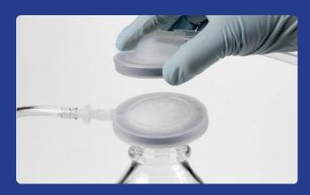
1.ホルダーベースをボトルの上に置き、メンブレンを清潔で乾燥したフィルターサポートの上に置きます。
